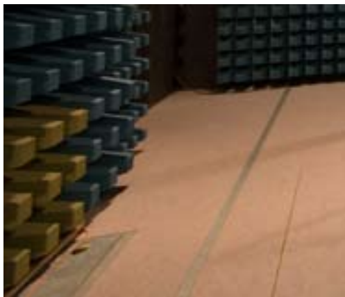
Polo Scientifico Tecnologico - Camera semi-anechoica per misure di compatibilità elettromagnetica
