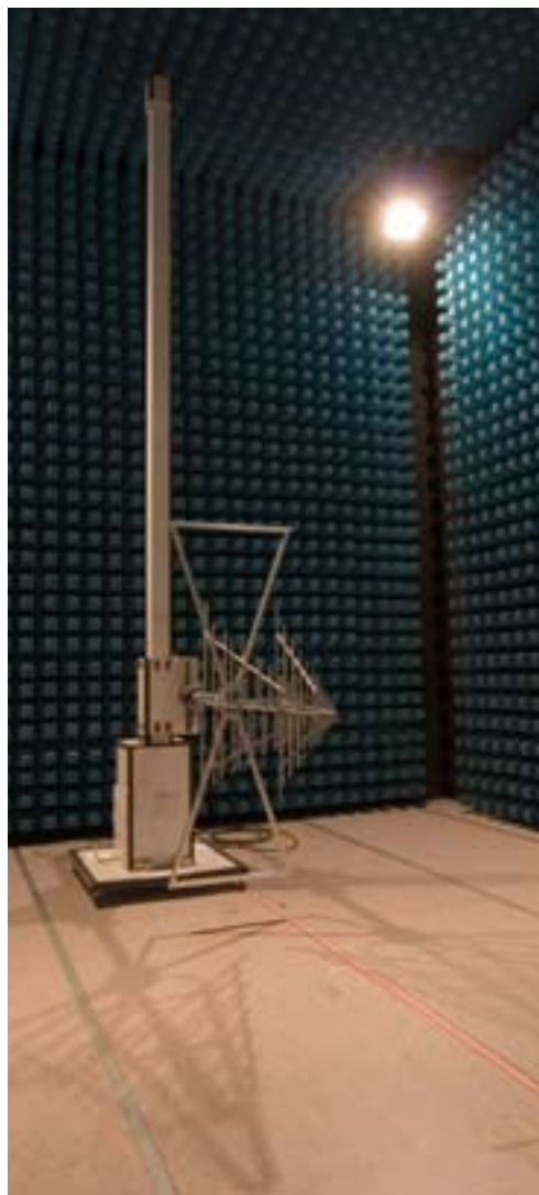
Polo Scientifico Tecnologico - Camera semi-anechoica per misure di compatibilità elettromagnetica
